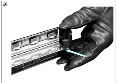
PLACE THE PLASTIC BASE PLATE AGAINST THE SUPER 123 UPRIGHT CUPPING FIRST THE CENTRE RIB FOLLOWED BY THE CONNECTION FACE.
